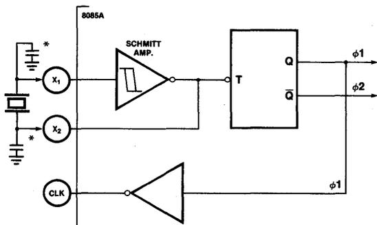
\*EXTERNAL CAPACITORS REQUIRED ONLY FOR CRYSTAL FREQUENCIES ≤ 4MHz.
