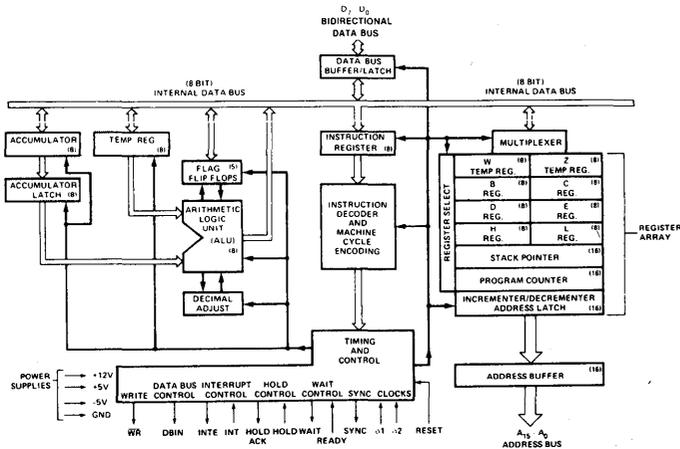
**Figure 1. Block Diagram**
