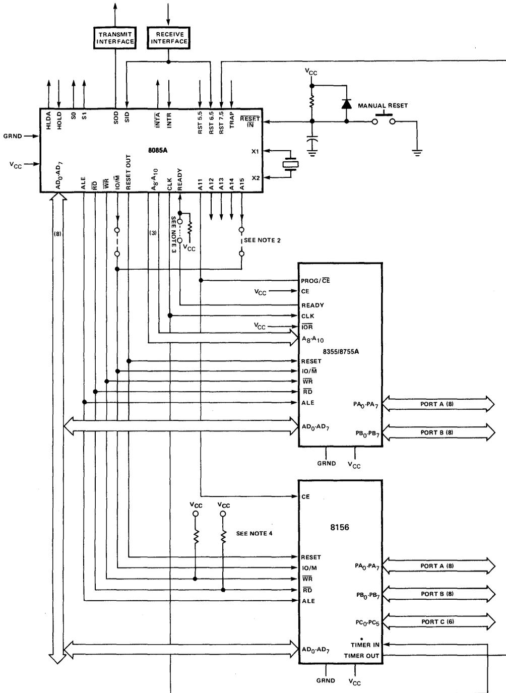
FIGURE 2. MINIMUM SYSTEM CONFIGURATION
