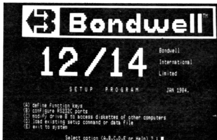
Afb. 7 Het „SETUP” programma, waarmee de Bondwell-12 hardware kan worden ingesteld.
