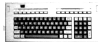
Afb. 4 Het toetsenbord van de Bondwell-12. De bovenste rij toetsen zijn zelf te definiëren.
