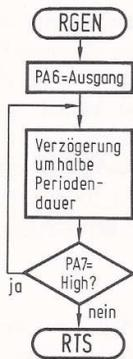
Abb. 6.2.1 Flußdiagramm zum Rechteck-Generator
