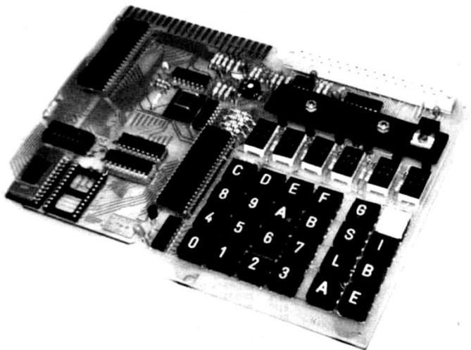
**Bild 3.** Ergänzt man ein einfaches Mikrocomputersystem mit einer Zifferntastatur und einem LED-Display, so kommt man zu dieser Konfiguration (CT-65, Testbericht in mc 4/1983)
