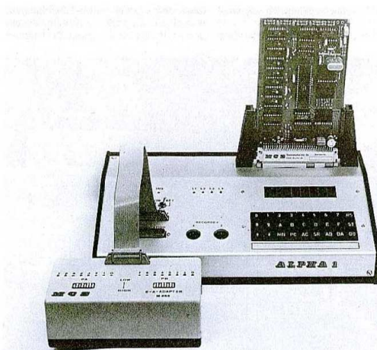
Bild 5: Für erste Interface-Gehversuche dient der E/A-Adapter M 655
