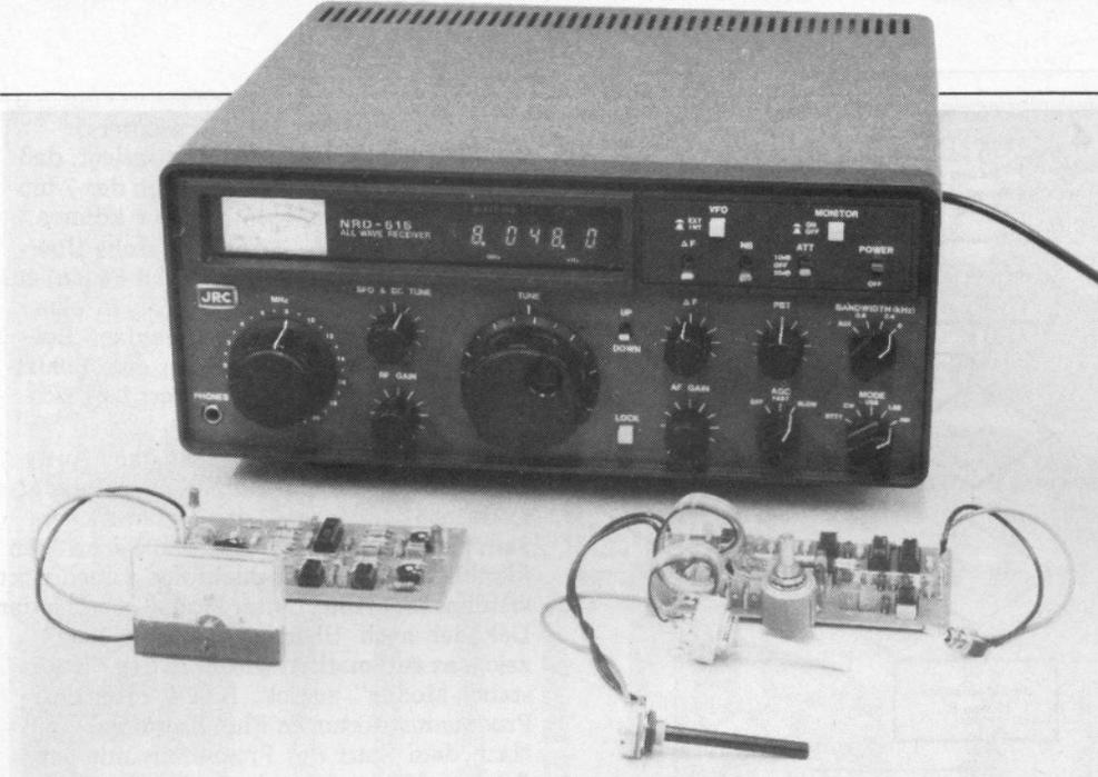
Leuchten. Wenn die LEDs mit ihrem Blink- und Leuchtverhalten guten Empfang signalisieren, muß man noch die richtige Baudrate (Einstellung am Computer) und Polarität (Einstellung mit S2) herausfinden. Einfach so lange probieren, bis ein Textausdruck zustandekommt. Bleibt nur noch zu hoffen, daß es sich um keine Fremdsprache handelt.
