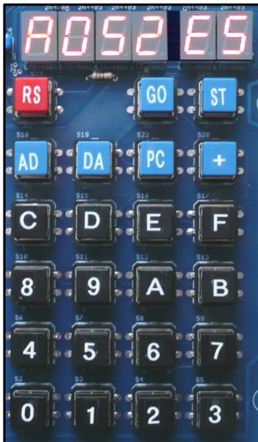
Abbildung 4: Die Tastatur bzw. die Anzeige des KIM-1 Clone
