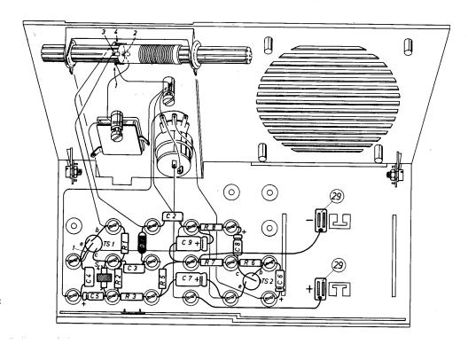
Montage van de diode en de transistoren
