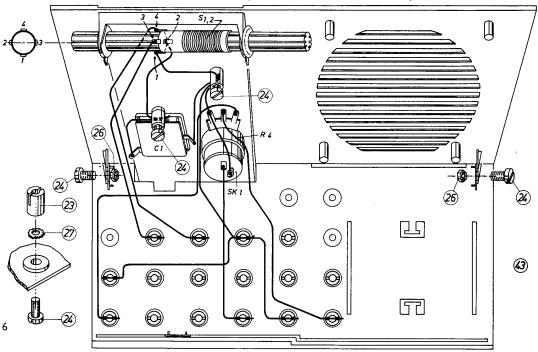
De rode draad welke van lip 1 komt, gaat naar de draadklem op de voorwand boven de potentiometer. De gele draad, die van lip 2 komt, gaat naar de draadklem boven de afstemcondensator. De grijze draad, welke van klem 4 komt, gaat naar een draadklem op de montageplaat. Als je de RE 1 bouwt, sluit je de groene draad welke van klem 3 komt, eveneens aan op een draadklem op de montageplaat. Bezitters van de RE 2 wachten nog even met de aansluiting van deze groene draad.
