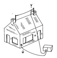
Beter is zelfs om hiervoor één doorlopende draad te gebruiken, waarin dus helemaal geen las voorkomt. Materiaal voor een antenne is niet in de RE-bouwdozen aanwezig, hoewel volledige aanwijzingen voor de aansluiting van een buitenantenne in dit boek zijn gegeven.
