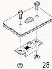
Pièce 36. Le commutateur écoute/parole. Percez le trou pour le bouton du commutateur qui est indiqué sur le schéma par un "trou de serrure". La manière de fixer le commutateur est illustrée à la Fig. 28. Utilisez deux longues vis.
