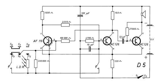
na de batterij en de luidspreker (zie hiervoor bij D 4). Is de LDR al op zijn plaats?
