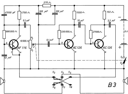
Van de nog niet aangesloten + pool van de onderste batterij (korte strip) gaat een geïsoleerde draad naar schakelaarcontact S 2. Vergeet ook niet de vrije min-pool van de bovenste batterij (lange strip) aan te sluiten op de draadklem waarbij B- staat. Rechts op de montagekaart zie je het luidsprekersymbool staan.
