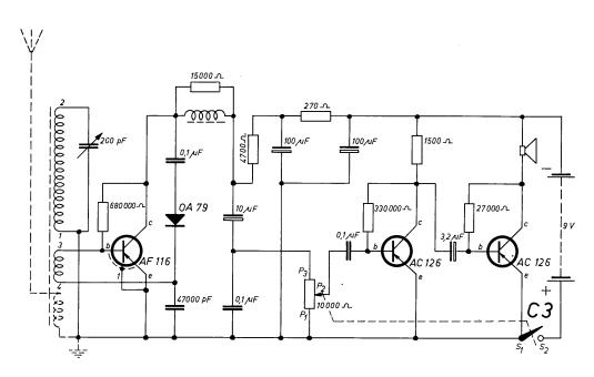
Voor twee dingen vragen we je bijzondere aandacht. Vergeet niet de koelvin op de rechter transistor AC 126 te plaatsen. Als je dit niet doet, dan zal je ontvanger wel spelen, maar het gevaar bestaat dat je toestel, als het een tijdje in staat, steeds zachter gaat spelen, en zelfs dat je transistor sneuvelt.
